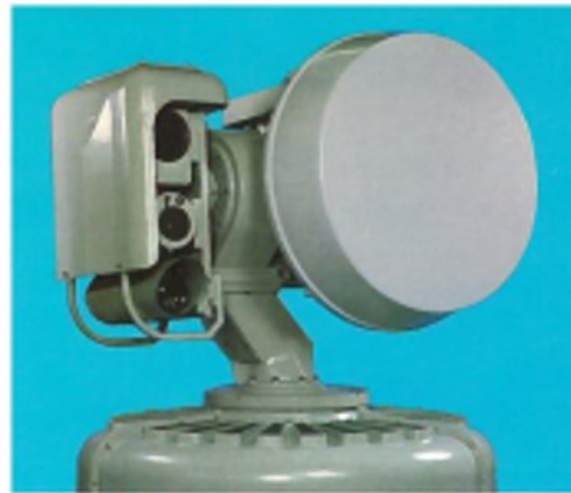
Bild 22. Sikte med polarisation (s.k. fågelbad)
