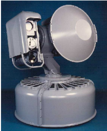
Bild 21. Sikte av ARTE 726 typ med TV,IR och laseravståndsmätare
